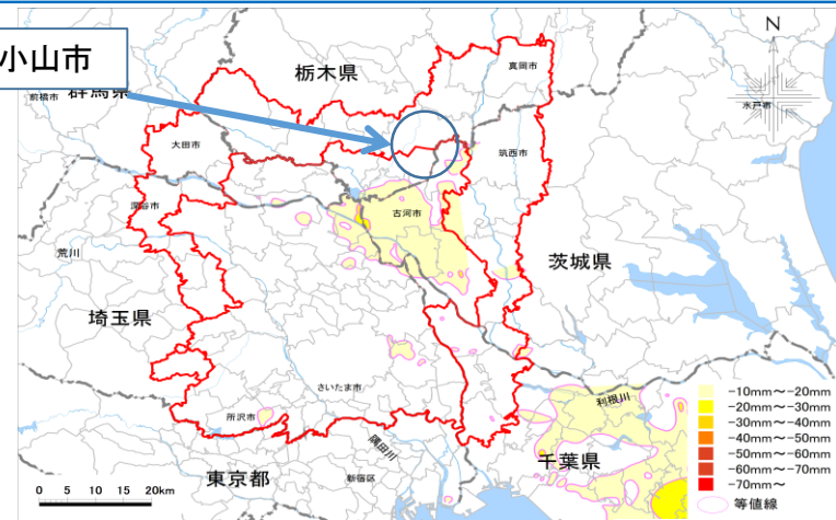
地盤沈下等量線図(平年(H14))
